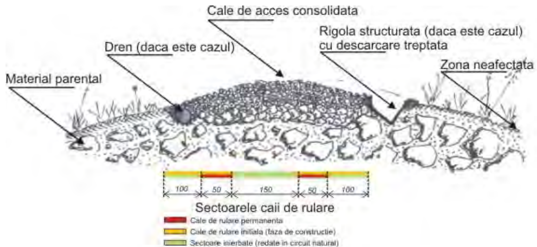
Figura 8. Structura transversală a drumurilor propuse (lățime 4-7m)
