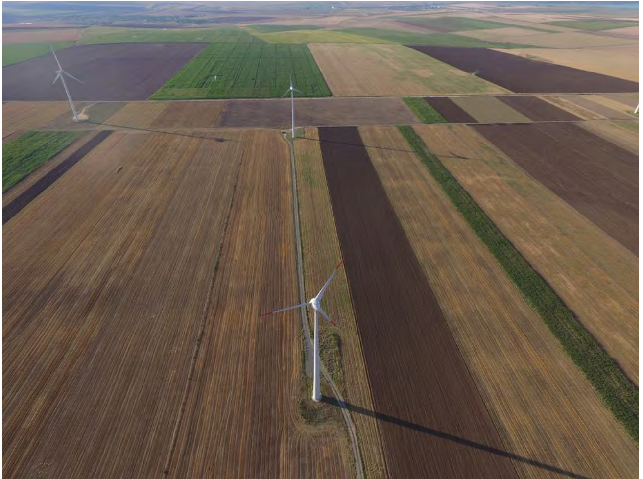
Figura 11. Parc eolian situat într-un amplasament cu funcțiune similară celui de la Berezeni 2 Se observă modalitatea de redare în circuit agricol/natural a fostelor platforme de lucru și amprenta la sol (impact rezidual) limitat al centralelor
