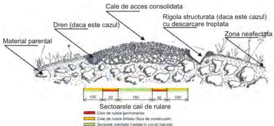
Figura 8. Structura transversală a drumurilor propuse (lățime 4-7m)
